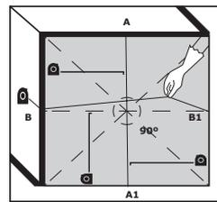
Определить центр помещения с использованием мелового шнура от центра стены А до середины противоположной стены В1. Затем провести линию от середины стены В до середины противоположной стены А1. Угол пересечения двух линий должен составлять угол 90 градусов.
