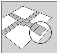
Проверить размеры помещения, измерив рулеткой или уложив плитки от центра до стен (без использования клея). Ширина плитки у стен (или в углах) должна быть одинаковой и как минимум 5 см. При необходимости повторить предыдущий шаг, начертив новые параллельные линии относительно первых.
