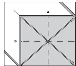
При укладке по диагонали нанести отметку меловым шнуром от пересечения линий А и В. Угол пересечения двух линий должен составлять 45 градусов.
