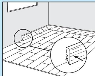
Если при укладке нового напольного покрытия имеется порог или дверной проем, рекомендуется подрезать наличники. Чтобы правильно выполнить подрез, переверните планку и приложите ее на полу к дверной коробке. Затем положите ножовку на планку и просто подрежьте дверную коробку. Удалите выпиленный брускок и соберите мусор с помощью пылесоса.
