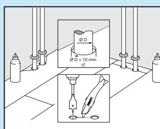
Если отверстия располагаются с длинной стороны планки, выполните разрез под углом 45 градусов от каждого отверстия к краю панели. Затем приклейте ее на место. Заполните стыки вокруг трубы.
