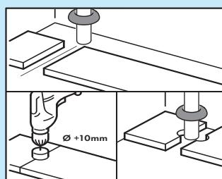
Если две трубы расположены рядом, просверлите в каждой намеченной точке отверстие диаметром, равным диаметру труб.
