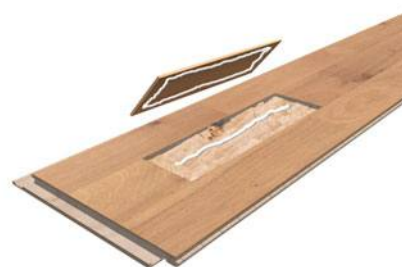
Выберите и подгоните новую плашку. Заполните полость полиэфирным наполнителем и прижмите плашку.
