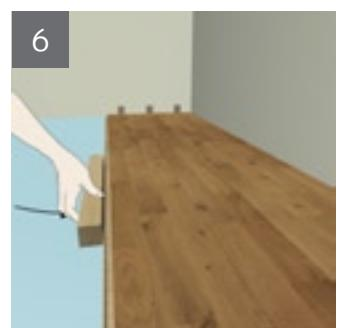
**4.** Вставьте доску второго ряда под углом в паз первого ряда, фиксируя ее, одновременно осторожно прижмите ее, укладывая горизонтально на пол.
