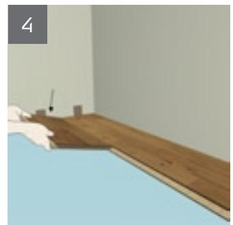
**3.** Отпишите последнюю доску первого ряда до нужной длины и начинайте следующий ряд с оставшегося отрезка. Торцевые соединения паркетной доски должны быть смещены на расстояние не менее 500 мм.
