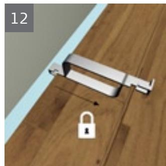
**13.** При необходимости паркетную доску можно укладывать в любом направлении. Woodloc® 5S также легко снять. Используйте специальный инструмент (крючок) так же, как при закреплении пола. Направьте инструмент к себе и переместите фиксирующие язычки в открытое положение, что позволит легко снять пол.
