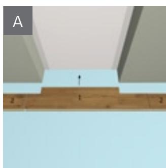
**B.** При укладке вокруг дверной коробки следует уложить доску как можно ближе к дверной коробке, а затем осторожно подбить с торца. Чтобы не испортить доску, используйте обрезок для ее защиты.
