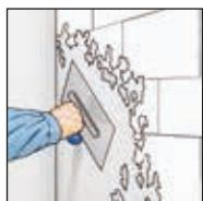
1. Удалить старые обои и покрытия. Шероховатые основания выровнять гипсодержащей шпаклевкой. На сильно впитывающие основания нанести грунтовку, не содержащую растворителей.
