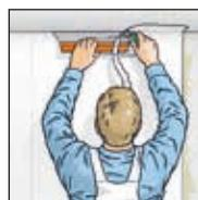
5. Излишки у потолка, плинтусов, окон и т. д. удалить с помощью монтажного ножа и обойного шпателя.
