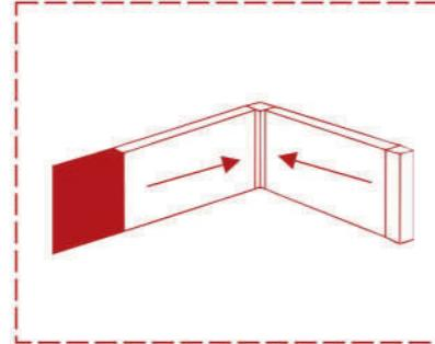
БЕРЕМ ВТОРУЮ ЗАГОТОВКУ, ПРИЖИМАЕМ К СТЕНЕ, ЧТОБЫ ИЗЛИШКИ
