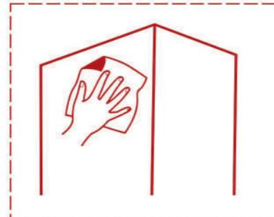
НАНОСИМ КЛЕЙ НА БОКОВОЙ КРАЙ УСТАНОВЛЕННОГО ПРОФИЛЯ,
