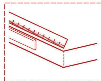
ПРОВЕРЯЕМ ТОЧНОСТЬ ПОДГОНКИ, ПРОТИРАЕМ ВЕТОШЬЮ
